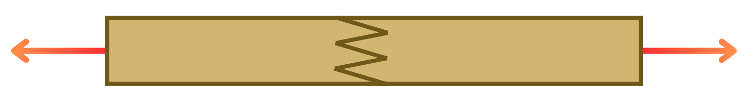
Essais de traction pour évaluer l'aboutage encollé au polyuréthane
