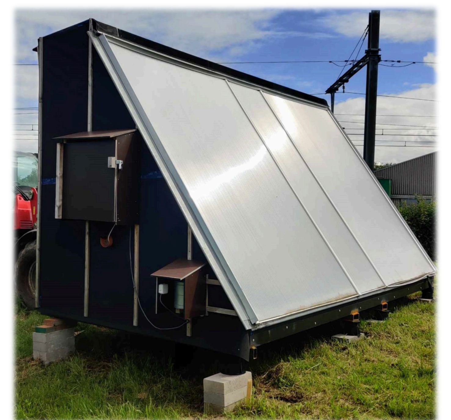
Séchage dans un four traditionnel et un four à séchage solaire, développé par Copains Des Bois
